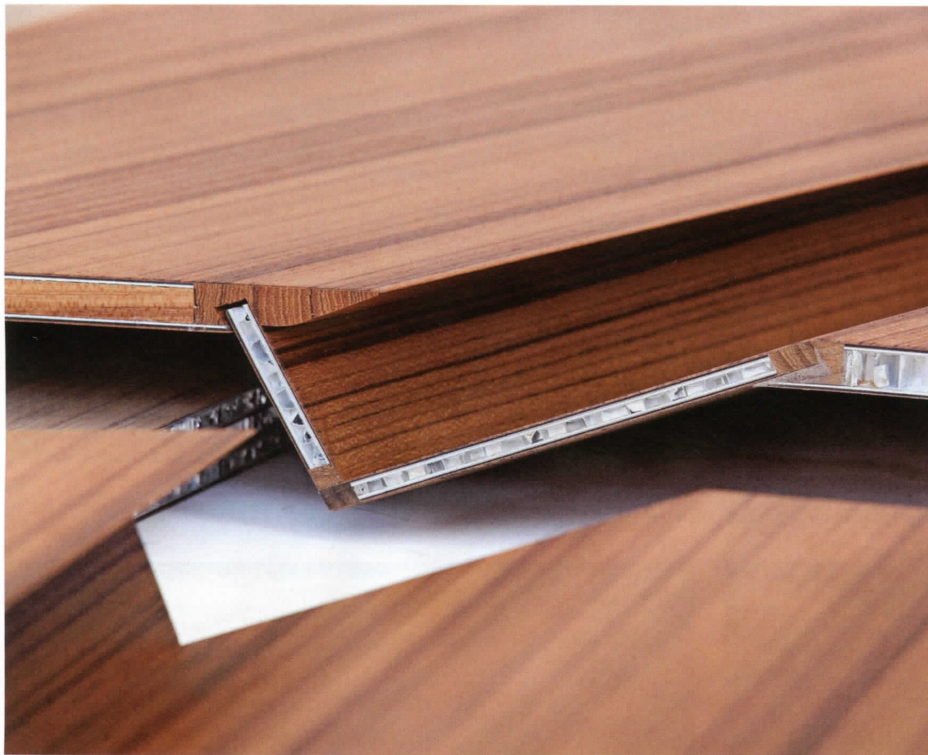
/ Filigran, präzise und überaus stabil: Bei diesem Objekt ist der gekonnte Umgang mit unterschiedlichsten Werkstoffen – Furniere, Massivholz und Aluminium-Wabenplatten – gefragt.
