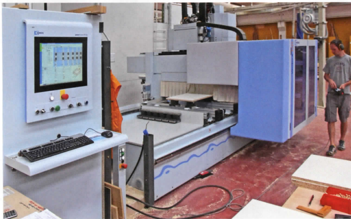
/ Höller hat zwei Homag-Bearbeitungszentren im Einsatz: Eine Fünfachmaschine Venture 316 L sowie ein BAZ Optimat 311 (vier Achsen).
